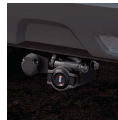
Rozłączalny zaczep holowniczy (63) zamontowany/zdjęty. Po zdjęciu zaczepu zakryj otwór w zderzaku zaślepką, by zapobiec przedostawaniu się tam błota i kurzu.
